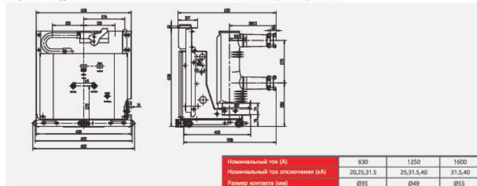
Рисунок 2. Вакуумный выключатель выкатного исполнения ZN63 (VS1) для шкафов 800 мм
