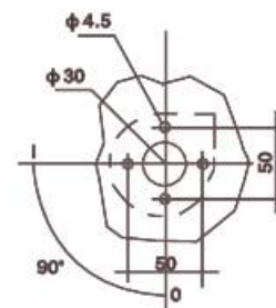
YCHGL(B) 125-630A размеры монтажной панели ручки управления с дверцы шкафа
