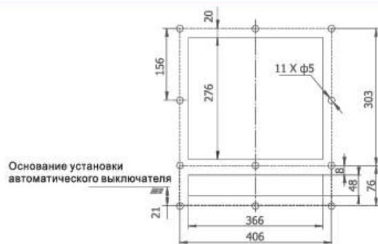
Размеры проема в дверце шкафа
